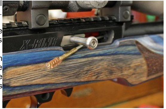
Faites passer le câble par le port d'éjection.
