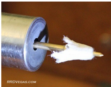
Collier d'arrêt de la baguette de nettoyage Arrêtez ici!! Pousser plus loin est un gâchis
