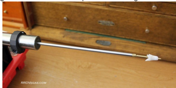
Collier d'arrêt de la baguette de nettoyage Arrêtez ici!! Pousser plus loin est un gâchis
